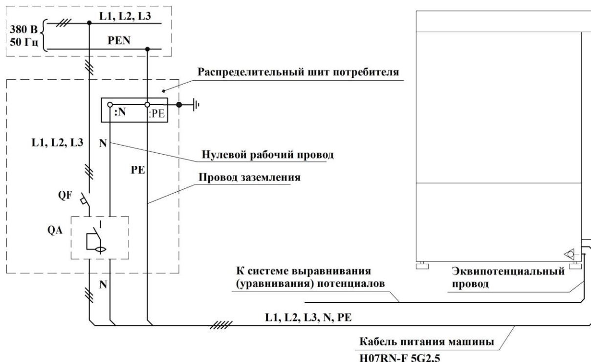
Рисунок 7 – Схема подключения к электрической сети
